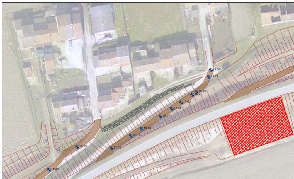
Figura 4-17 - Sviluppo planimetrico del muro in gabbioni.
